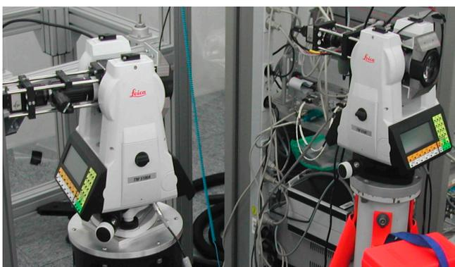
Abb. 3: i3mainz-Digitalkamera-Theodolite für automatisierte und kinematische Kollimations- und Autokollimationsbeobachtungen. Mit freundlicher Genehmigung der Tesat-Spacecom GmbH & Co. KG
