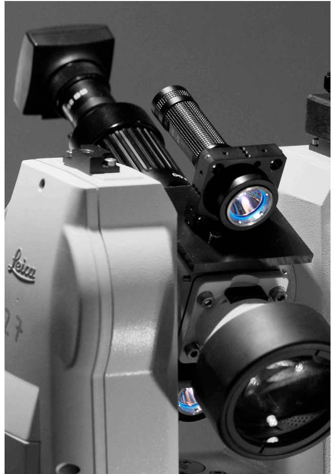
Motortheodolit Leica TM5100 mit modularer Kamera und LEDs
