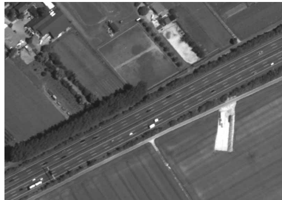
Geometrische Entzerrung auf eine Horizontalebene im Objektraum
