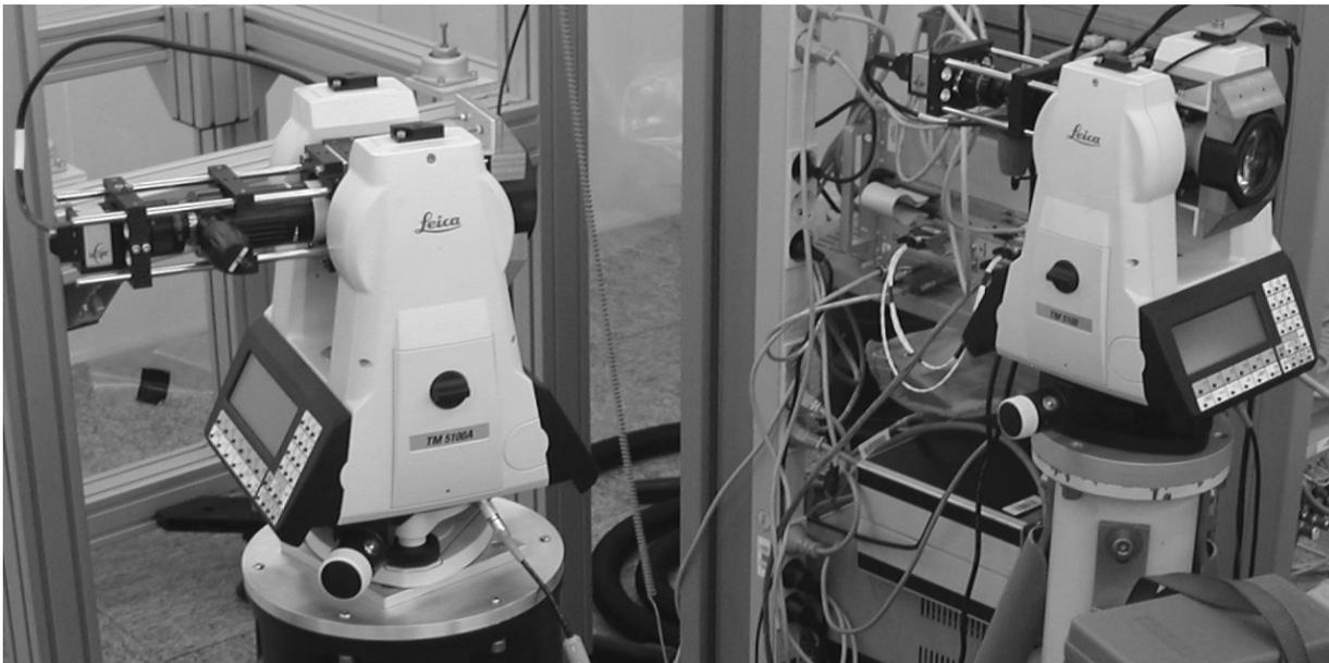
Abbildung 2: Digitalkameratheodolite auf Basis Leica TM5100™ bzw. TM5100A™
